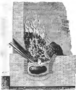
Fig. 166. — Coupe verticale d'une forge catalane.
